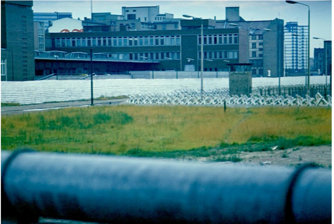
Die Grenzmauer im Vordergrund ist mit einer Rohrauflage gegen Überklettern gesichert. Der Grenzstreifen ist mit Grenzleuchten, einer Doppelreihe Fahrzeugsperrern, einem Zaun und einem Wachturm gesichert. Im Hintergrund ist entlang der weiß gestrichenen Grenzmauer aus geschichteten Betonplatten das Druckhaus des Springer-Verlags erkennbar.
